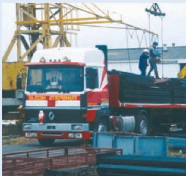
1.2 Door het geringe eigen gewicht is voor een kleine hal vaak één transport naar de bouwplaats voldoende.
