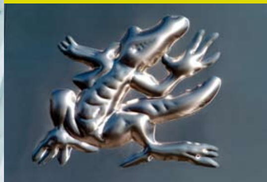
Roestvast stalen plaat met hydromechanisch aangebracht 'draakje'
