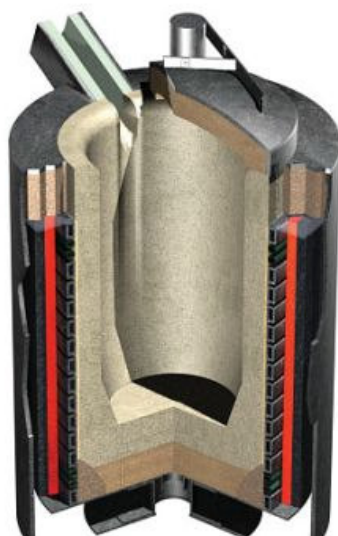
Figuur 15 kernloze inductieoven, bron [79]
