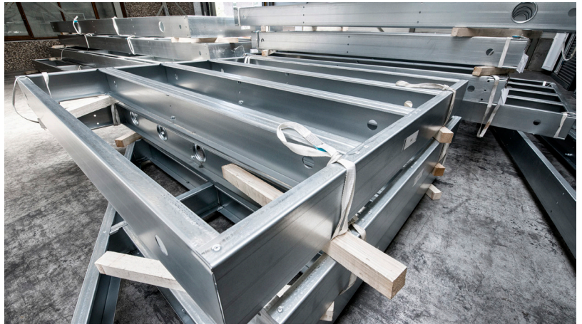
8.1 Transport: stootbescherming en afstandhouders voor hijslint (foto: Finish Profiles).
