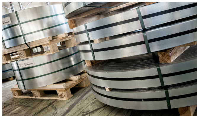
3.4. Geslitte rollen (foto: Finish Profiles).
