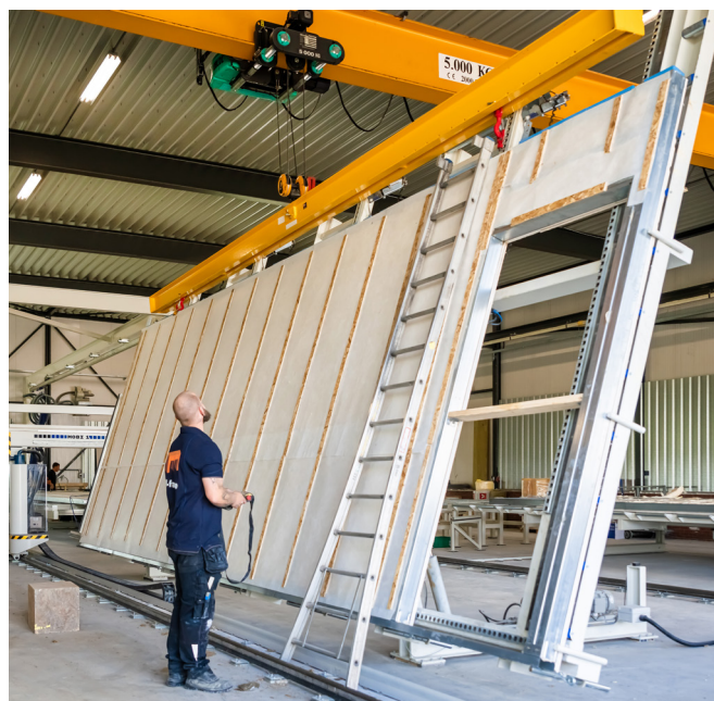
3.16.a. Volautomatische gipsmachine, voor totaal prefab elementen en b. Kantelmachine (foto's: MFrame).
