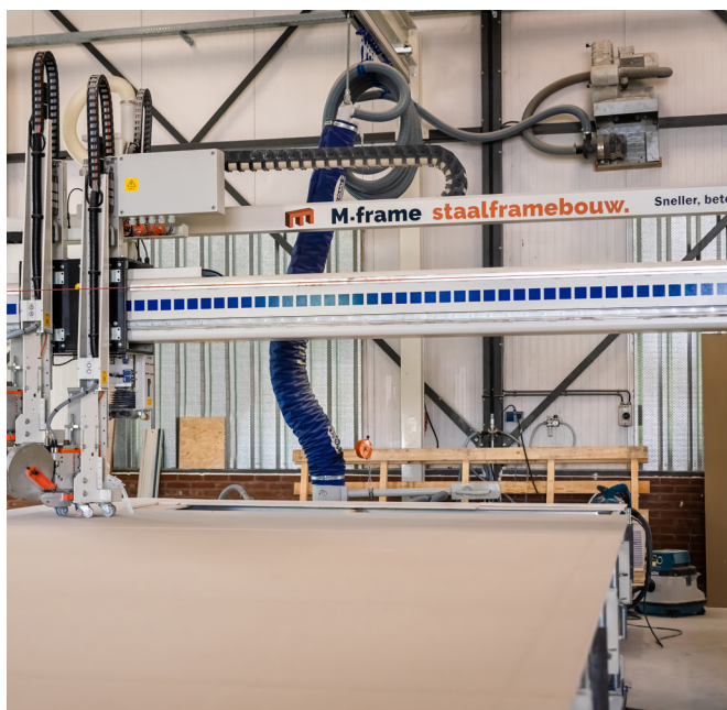
3.16.a. Volautomatische gipsmachine, voor totaal prefab elementen en b. Kantelmachine (foto's: MFrame).
