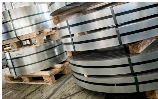
2.21. Geslitte staalrol/bandstaal (coil).
