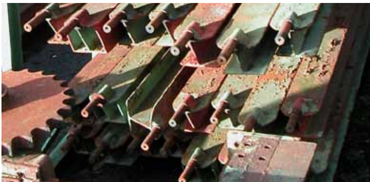
9.3a Een electro-oven gebruikt 100% gerecycled staal.
