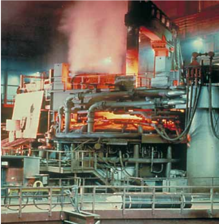
9.3a Een electro-oven gebruikt 100% gerecycled staal.
