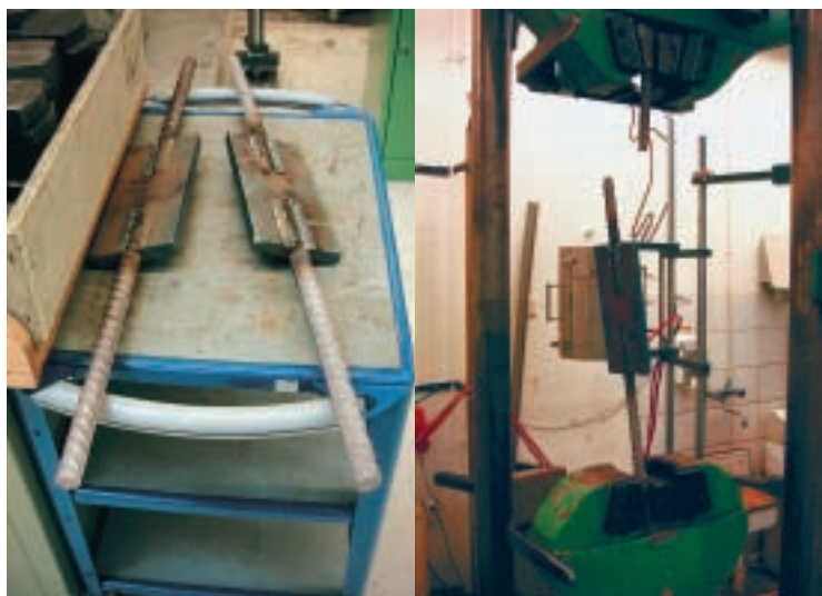
31. Alle verschillende typen lasverbindingen zijn in het laboratorium beproefd op sterkte.
