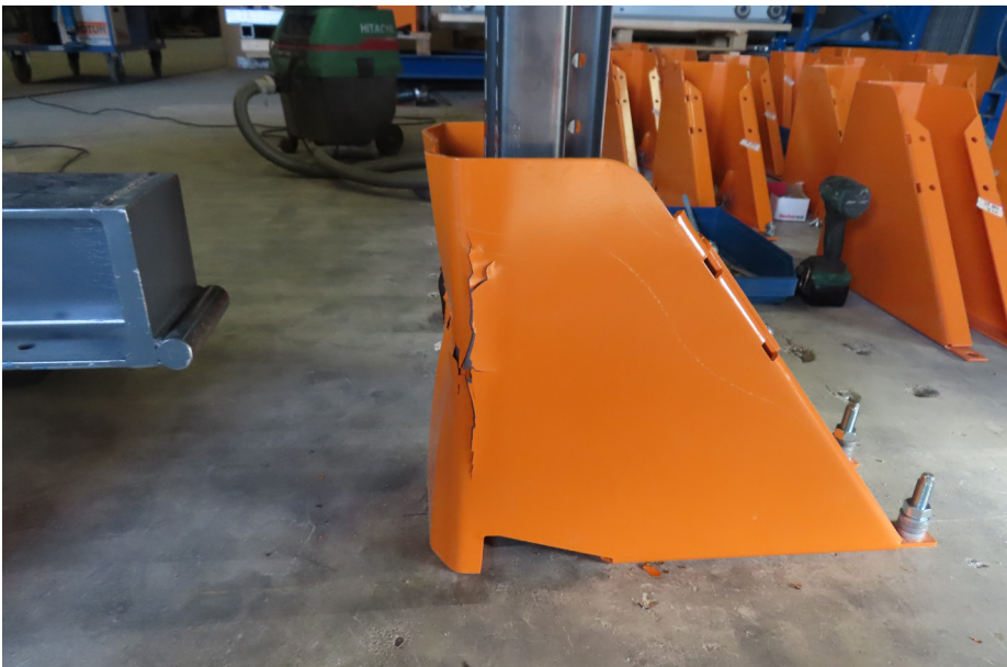
12. Voorbeeld vrijstaande aanrijdbeveiliging na impact (foto: Nedcon).
