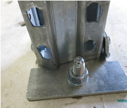
13. Belastinggeval aanrijding. Randvoorwaarde staander-vloer aansluiting (l) Met één anker minder incasseringsvermogen, want kan geen torsie opnemen (boven). Met twee ankers (r). Proefopstelling meting 'prying force' (foto's: Nedcon).
