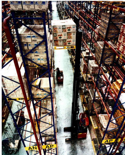
1. Palletstelling in interactie met een reach truck (hefhoogte tot ~ 12,5 m).
