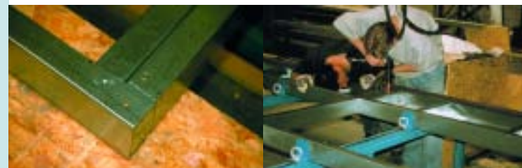
afb. 5.14 Het uiterlijk van een clinchverbinding.
