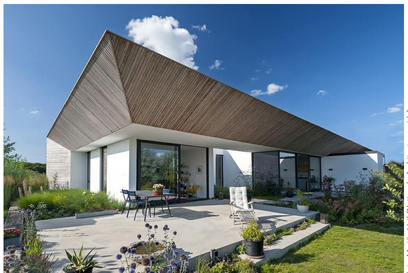
4.32b Ontwerpmaatregel: zoninstraling beperken met overstek.
