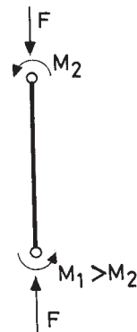
* afb. 115. Op druk en buiging belaste staaf.
