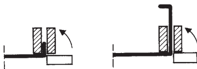
afb. 13. Schematische voorstelling van de werking van een zetbank
