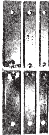
afb. 92. Boutverbinding bezwiken op stuk.
